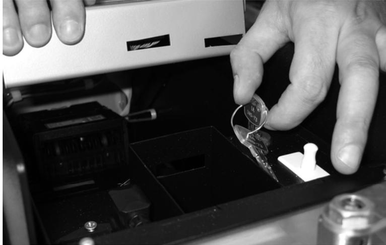
Das Kabel des Lesers abtrennen und den Leser aus seinem Anbauflansch lösen, indem die entsprechende Auslösetaste betätigt wird.
