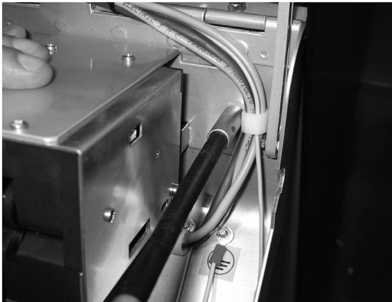
Die Verbindung des Kabel des Lesers von der elektrischen Platine des Geldwechslers lösen.
