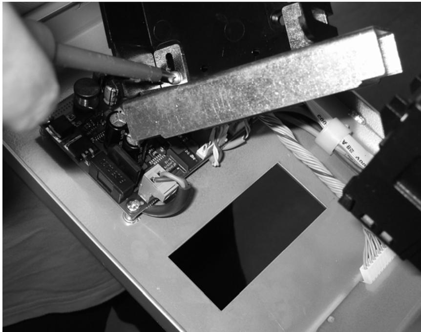
Münzmechanismushalterung auf dem Fenster mit rechteckigem Schnitt aufsetzen und Münzeinwurf von Außen festhalten, so dass die beiden Teile mit den verbleibenden zwei Schrauben befestigt werden können.
