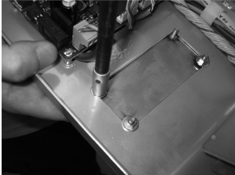
Den Metallbügel mit einem entsprechend bemessenen Kreuz-Schraubenzieher auf der Halterung des Münzmechanismus montieren (dabei zwei der vier mitgelieferten Schrauben verwenden).
