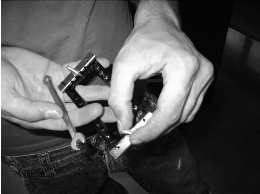
Oberen Bereich des Geldwechslers öffnen und Anschlussflansch an das Fenster mit quadratischem Schnitt der Haube (von der Außenseite) anlegen; die Halbleche des Vorderteils in ihre Position bringen und mit den beiden vorher entfernten Muttern M4 befestigen (Maulschlüssel 7 mm verwenden).
