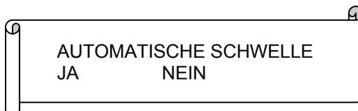
Wenn die automatische Schwelle gewählt wird, muss der Wert für die Ausgabeschwelle eingegeben werden.
