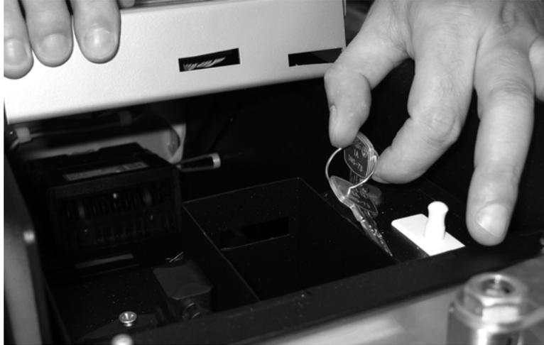
Das Kabel des Lesers abtrennen und mithilfe eines Steckschlüssels 7 mm die beiden Muttern, die den Haltebügel an der Haube halten, lösen.
