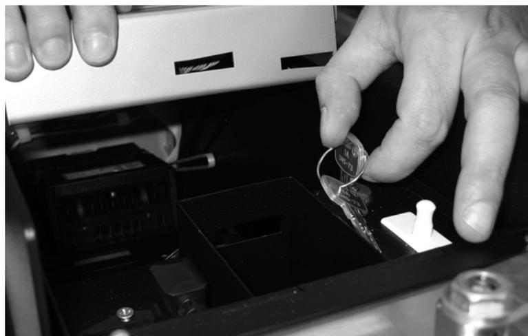
Mit einem Steckschlüssel (7 mm) die vier Muttern lösen, die den Münzmechanismus-Deckel auf der Haube befestigen.
